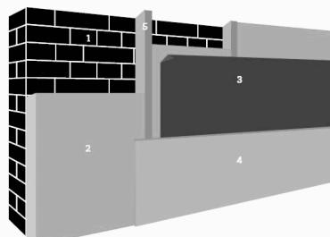
1. Buitenvlak | 2. Isolatie | 3. Vochtscherm | 4. Afwerkingslaag | 5. Stijl- en regelwerk (optioneel)
