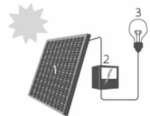
1. Zonnepaneel | 2. Omvormer | 3. Elektrische toestellen
