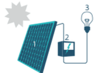
1. Zonnepaneel | 2. Omvormer | 3. Elektrische toestellen
