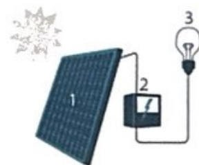
1 Zonnepaneel | 2 Inverter | 3 Elektrische aansluiting
