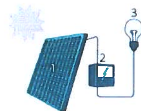
1. Zonnepaneel | 2. Omvormer | 3. Elektrische toestellen
