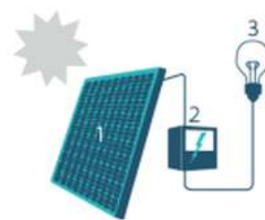
1. Zonnepaneel | 2. Omvormer | 3. Elektrische toestellen
