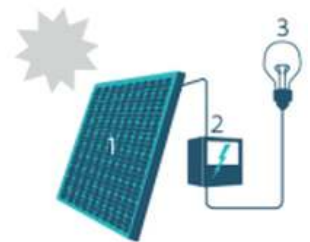
1. Zonnepaneel | 2. Omvormer | 3. Elektrische toestellen
