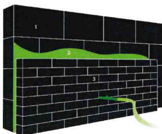
1. Dragende muur | 2. Ingeblazen isolatie | 3. Gevelsteen / gevelbekleding
