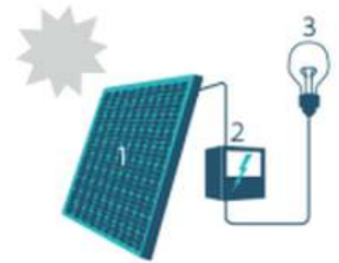
1. Zonnepaneel | 2. Omvormer | 3. Elektrische toestellen
